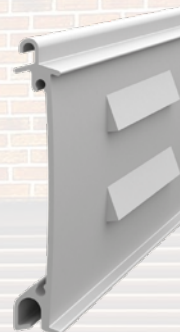
Lüftungslamelle 12 Stanzungen pro lfm à ca. 0,0048 m 2
